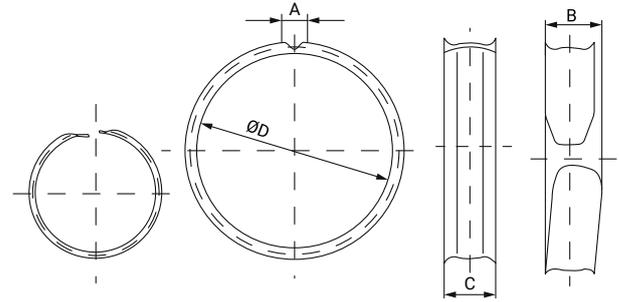
La bague de sécurité pour des colliers ASFA S avec largeur de bande de 12 mm a été conçu pour une plus grande protection du tube.
