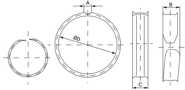
La bague de sécurité pour des colliers ASFA L avec largeur de bande de 9 mm a été conçu pour une plus grande protection du tube.
