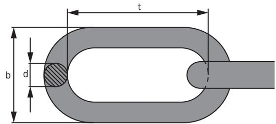
La chaîne au degré 80 est conçue pour sécuriser manœuvres de levage et traction. Étant l'élément principal des élingues en acier en combinaison avec les différents accessoires et avec un calcul correct de la charge maximale, elle garantit opérations au niveau maximal de sécurité.
