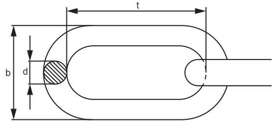
Ce type de chaîne du type droit est la plus utilisée dans les emplois les plus communs. Il existe une relation directe entre le diamètre du fil, le pas du lien et son ampleur, cette relation permettant que ses caractéristiques mécaniques fassent en sorte que toute utilisations soit menée sans problèmes. Le traitement zingué permet augmenter la résistance à la corrosion en donnant un finissage très esthétique.
