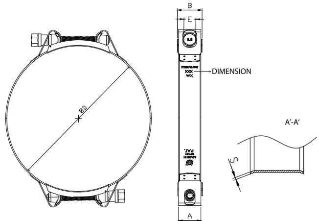
Le collier à double serrage représente une solution idéal pour tout montage où peut-on avoir le besoin d'augmenter l'herméticité des applications et d'avoir une distribution optimale de la force de serrage appliquée sur la circonférence de la bande.
