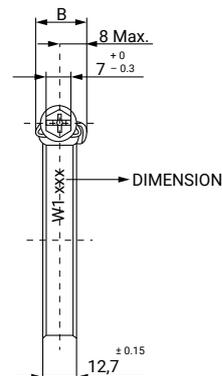
Les colliers ASFA L (9 mm) avec bague intégrée en inox sont envoyés déjà montés et sont conçus pour donner une majeure protection au tube lorsque se produisent des fortes vibrations pendant des longues périodes de temps.
