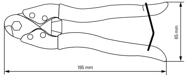
Permet des coupes précises et propres avec une manipulation à une main. Il est conçu pour couper des câbles en acier de petit diamètre. Son design ergonomique permet d'appliquer la force nécessaire sans abîmer la main et sa poignée en caoutchouc est auto-coulissante.
