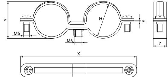
Ce collier de serrage se fixe généralement sur les plafonds et permet de faire passer deux tubes parallèles du diamètre que l'on souhaite. Il est fixé au mur à l'aide d'un vis et d'une cheville, puis le double collier est vissé.
