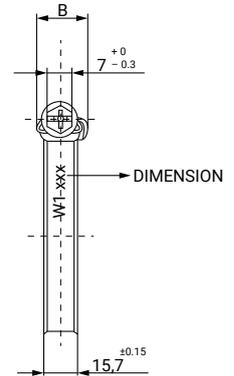
Les colliers ASFA S (12 mm) avec bague intégrée en inox sont envoyés déjà montés et sont conçus pour donner une majeure protection au tube lorsque se produisent des fortes vibrations pendant des longues périodes de temps.
