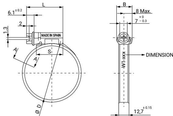
Les colliers ASFA L (9 mm) avec bague intégrée en inox sont envoyés déjà montées et son conçus pour donner une majeure protection au tube lorsque se produisent des fortes vibrations pendant des longues périodes de temps.
