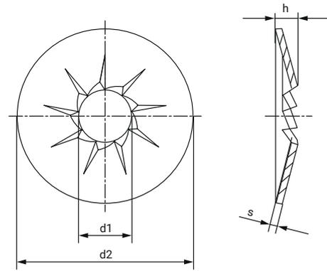
La rondelle choisie doit largement dépasser la surface du point de poinçonnage ou de la rainure d'appui, afin d'obtenir une surface d'appui suffisante, ce qui offre l'avantage de pouvoir diminuer la pression spécifique par unité de surface pour les matériaux qui ont une dureté inférieure à l'acier.
