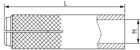
Cette ancre est très simple à appliquer et fonctionne par expansion. Par un coup à l'intérieur avec les soi-disant expandeurs, elle déplace un cône qui est inséré à l'intérieur de sorte qu'elle dilate l'ancre de sa partie inférieure, ce qui provoque des frottements sur les parois du trou effectué et de cette manière l'ancrage est effectué.
