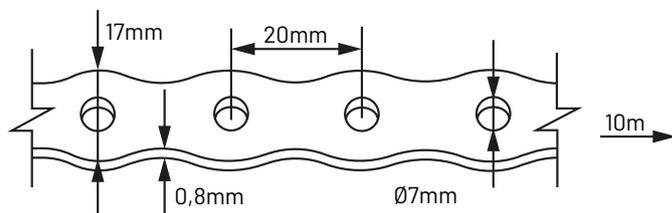
Cette bande est en acier galvanisé et est toute perforée, longitudinalement. Elle sert à maintenir tout élément que l'on souhaite fixer par vissage aux murs, plafonds ou sols. La perforation sur toute la bande nous permet d'avoir toujours un trou pour insérer un vis. Largement utilisé dans des secteurs tels que l'électricité, l'assainissement et la construction.
