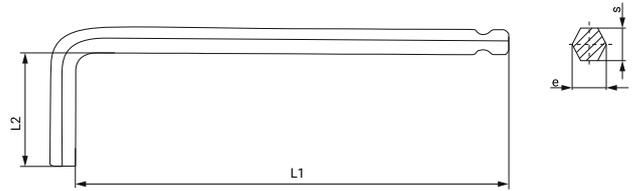
La clé Allen longue à bille DIN 911 est un outil utilisé pour visser efficacement tous les types de vis dont la tête comporte un trou hexagonal adapté à l'insertion de la clé. Il s'agit d'une clé avec une extrémité sphérique usinée dans le bras long, spécialement conçue pour permettre le serrage lorsqu'elle n'est pas complètement alignée avec la vis et que l'espace est difficile d'accès.
