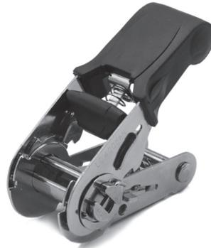
Le dispositif d'arrimage est un accessoire métallique conçu avec des mécanismes articulés adaptés au serrage des sangles d'arrimage. C'est un accessoire essentiel pour la fonctionnalité des systèmes d'arrimage pour charges lourdes, de plus, son application correcte évite d'éventuels dommages dus à des coups, frottements, déplacements ou renversements pendant le transport de la charge.
