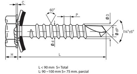
La vis autoperceuse avec rondelle est en acier cémenté. La rondelle incorporée dans la conception de la tête, permet de tenir une plus grande surface. Ce type de vis est principalement recommandé pour une application directe sur des tôles ou des profilés en acier et en aluminium. Parfait pour la fixation aux façades et aux revêtements métalliques sur les structures en acier, en particulier dans les applications extérieures.
