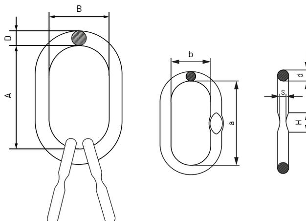
L'anneau maître est assemblé avec deux anneaux plus petits, qui permettent le levage ou le transfert de charges importantes au moyen de plusieurs bras qui garantissent une sécurité fonctionnelle optimale.
