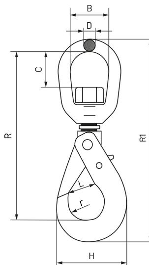
Le crochet autobloquant rotatif est adapté à une utilisation avec une chaîne à 80°. Le dispositif autobloquant vous permet d'obtenir la garantie maximale en termes de sécurité. La force de traction propre de la charge empêche son ouverture accidentelle. La structure annulaire rotative facilite la mobilité directionnelle de la charge. La conception de l'écrou d'assemblage du crochet avec la bague rotative au moyen d'un axe DIN 1481 empêche son desserrage.
