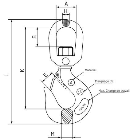
En raison d'une conception appropriée, d'un forgeage soigné et d'une précision contrôlée du traitement thermique, la charge maximale est obtenue sans poids ni volume de crochet excessifs. Une goupille DIN 1481 placée au centre de l'écrou et dans la partie filetée du crochet assure une connexion parfaite sans possibilité de desserrage qui garantit une sécurité fonctionnelle maximale.
