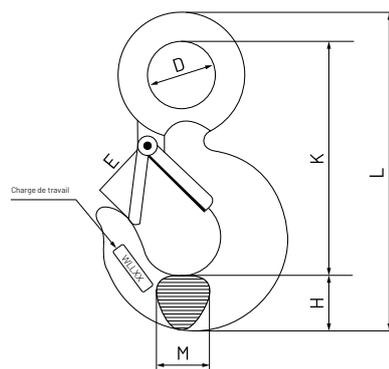
La qualité du ressort d'actionnement de sécurité lui confère une fonctionnalité rapide sans altérer la sécurité que doivent comporter les charges de levage ou de déplacement. Chaque crochet est marqué en relief avec sa charge utile correspondante en tonnes et avec le symbole d'identification du type de matériau : (C) pour les crochets en acier au carbone et (A) pour les crochets en acier allié, garantissant votre choix.
