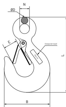
La qualité du ressort d'actionnement de sécurité lui confère une fonctionnalité rapide sans altérer la sécurité que doivent comporter les charges de levage ou de déplacement. Chaque crochet est marqué en relief avec sa charge utile correspondante en tonnes et avec le symbole d'identification du type de matériau : (C) pour les crochets en acier au carbone et (A) pour les crochets en acier allié, garantissant votre choix.
