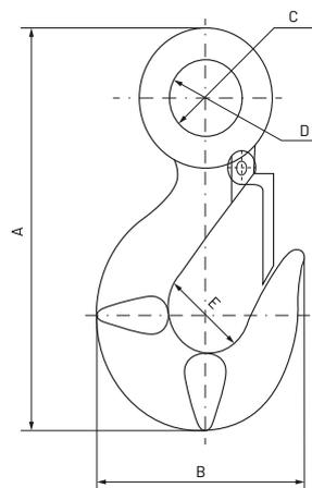
La qualité du ressort d'actionnement de sécurité lui confère une fonctionnalité rapide sans altérer la sécurité que doivent comporter les charges de levage ou de déplacement. Chaque crochet est marqué en relief avec sa charge utile correspondante en tonnes et avec le symbole d'identification du type de matériau: (C) pour les crochets en acier au carbone et (A) pour les crochets en acier allié, garantissant votre choix.
