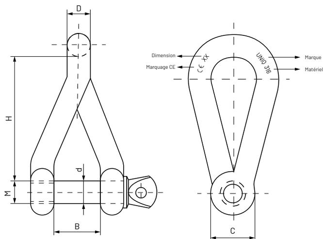
Le virage à 90° de l'arc de la manille torsadée est vraiment utile lorsque la contrainte est perpendiculaire à l'axe de la manille.
