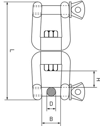
Son utilisation est la même qu'une manille classique, l'extraction du pêne permet un montage aisé au sein de la structure de l'élément à soulever ou à fixer. Ce qui la différencie de la manille classique, c'est que s'il y a des mouvements de rotation directionnels opposés, puisqu'il s'agit de 2 pièces différentes et qui tournent indépendamment, ils empêchent les chaînes, câbles ou cordes de se tordre.
