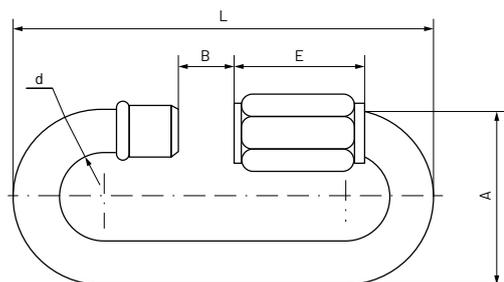
Le maillage rapide est un type de maillon très efficace pour réaliser des connexions de chaîne rapides. La forme hexagonale externe combinée au filetage interne du dispositif de fermeture garantit une fonctionnalité parfaite et une sécurité d'application optimale.
