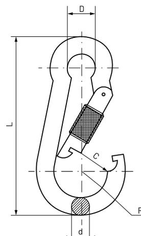
La DIN 5299 avec serrure a l'avantage que son ouverture due à une négligence, un frottement ou une erreur est entravée par le dispositif qui agit comme un dispositif de sécurité entre la charnière et le corps de DIN 5299.
