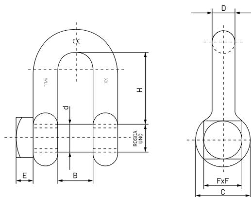
Le composant en acier à haute résistance de sa structure permet le levage de charges de travail importantes avec le choix d'une manille de plus faible volume et facilite ainsi sa manutention.
