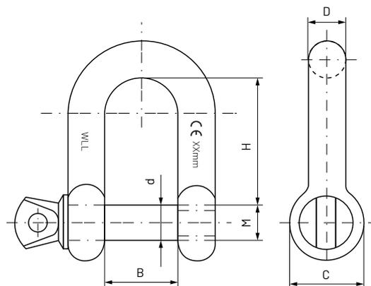
La manille droite est l'instrument de levage le plus fréquemment utilisé comme pièce intermédiaire entre un anneau, un anneau à viser ou un crochet et une élingue.
