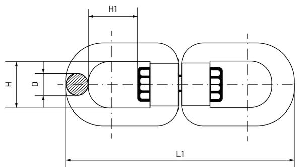
Les anneaux rotatifs sont particulièrement indiqués pour les applications où le levage de charges, éléments à transporter ou à attacher, nécessitent des mouvements directionnels opposés entre les deux extrémités, évitant les anneaux rotatifs que la chaîne ou la corde se tord.
