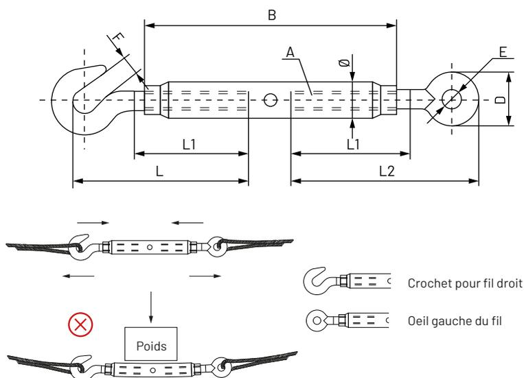
Le corps tubulaire sert à protéger le mécanisme d'enfilage des coups, éclats et autres éléments extérieurs à sa fonctionnalité. Son choix est également utile lorsqu'un résultat esthétique plus important est requis.
