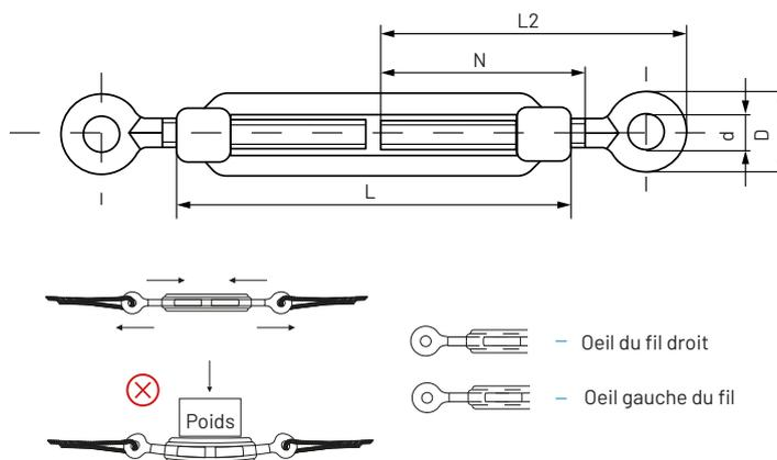
Particulièrement adapté aux applications où un niveau élevé de sécurité et une plus grande résistance à la traction sont requis grâce au tendeur à deux anneaux des deux côtés.
