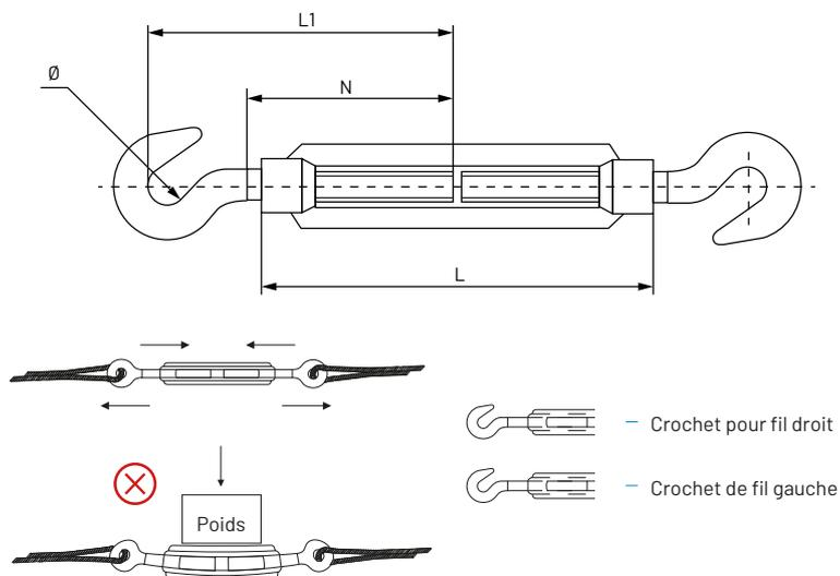
Particulièrement adapté aux applications où il est nécessaire de tendre des câbles avec des anneaux, des cordes à gaze, des chaînes, etc.
