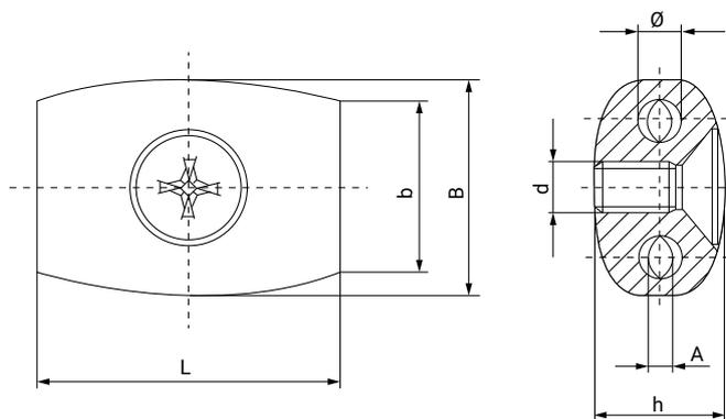
La conception des bandes existantes dans chacune des deux parties du serre-câble permet une prise rapide sur le câble une fois celui-ci assemblé. Particulièrement adapté aux assemblages avec des besoins purement esthétiques et pour les petits diamètres de câble.
