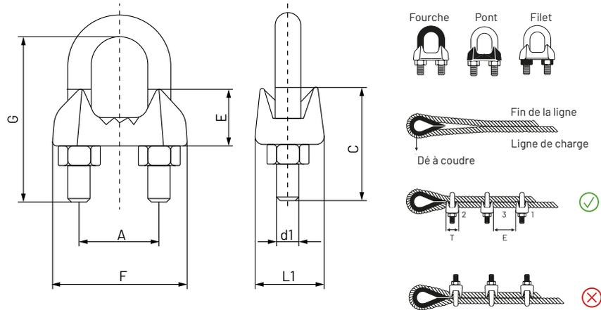
La structure malléable du presse-étoupe vous permet de réaliser des boucles de câbles ou des connexions entre les câbles là où ils ne peuvent pas être sertis, ni d'utiliser des cosse ou des connexions de câbles temporaires. Les rainures à l'intérieur de la base permettent une meilleure adhérence sur le câble.
