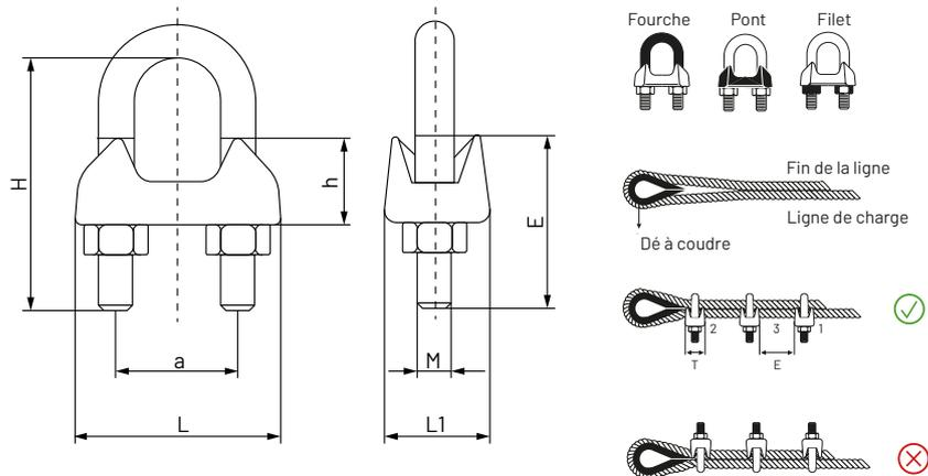
La structure malléable du presse-étoupe permet de réaliser des boucles de câbles ou des connexions entre les câbles là où ils ne peuvent pas être sertis, ni d'utiliser des cosses ou des colliers de serrage temporaires. Tous les serre-câbles sont marqués de la mesure correspondante à l'extérieur du pont, facilitant ainsi leur identification.
