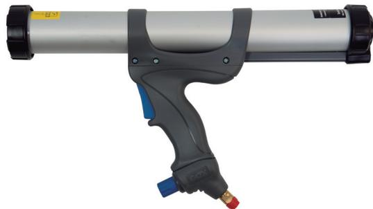
L'applicateur pneumatique professionnel est destiné aux applications industrielles, a une puissance de 1,5 KN et une pression de 6,8 bar. Il dispose également d'un mécanisme à action directe, il est silencieux (moins de 70 dB), compact et avec un contrôle précis grâce à son régulateur intégré. Convient pour les mastics à haute et basse viscosité.
