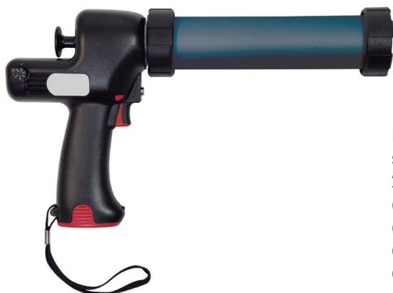
L'applicateur électrique tubulaire professionnel dispose d'une batterie Lithium Ion 7.4V-1, 3A, avec une force de 250 kg et une vitesse de 6.9 mm/sc. Il a un poids total (y compris la batterie) de 1.350 grammes, il est donc léger et confortable, il dispose également d'un système anti-goutte, d'un contrôle de vitesse et d'un éclairage LED pour travailler dans les zones à faible luminosité. Comprend un étui avec chargeur de batterie
