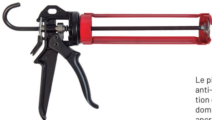
Le pistolet applicateur professionnel dispose d'un système anti-goutte pour éviter la perte de matière lors de l'application et d'une tige de traitement de surface qui évite les endommagements superficiels. Il est parfait pour appliquer des ancrages chimiques avec une viscosité moyenne à élevée.
