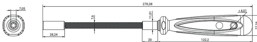
Tournevis essentiellement utilisé pour les colliers ASFA L et S.
