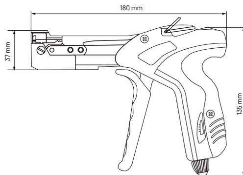
Outil pour la pose des colliers préformés. Dispose d'un dispositif qui règle la tension lors du serrage et effectue la coupe automatiquement.
