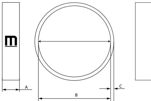
La bague de compression tubulaire se fabrique d'une seule pièce sans rivetage ni soudures pour garantir une excellente fixation, étant spécialement utilisée pour des montages en série.
