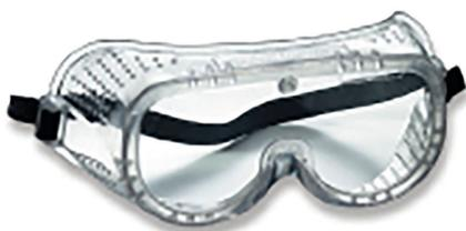
Ces monoobjectifs panoramiques sont fabriqués en plastique incolore et ont des trous de ventilation directs sur le côté. Ils sont recommandés pour tous types de travaux avec risque de décollement de matière et notamment avec la manipulation de liquides où il y a risque d'éclaboussures. Ils sont également compatibles avec les verres correcteurs.
