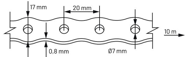
Cette bande est en acier galvanisé et est toute perforée, longitudinalement. Elle sert à maintenir tout élément que l'on souhaite fixer par vissage aux murs, plafonds ou sols.
