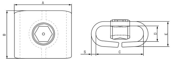
Cette boucle en acier inoxydable est spécifique aux sangles universels lourds en acier inoxydable. En frappant sur la boucle nous obtenons une pression sur le sangle l'empêchant de se détacher lors de son application.
