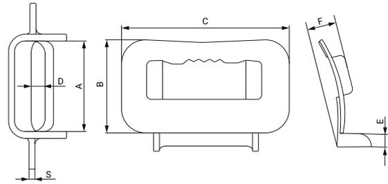
Cette boucle est fabriquée en acier inoxydable et peut être utilisée pour les bandes sans fin légères et lourdes. Une pression est exercée sur la bande lorsque la boucle est tapée, ce qui l'empêche de se détacher.
