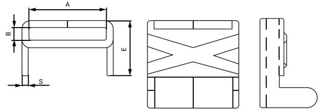
Ce boucle en inox est spécifique aux sangles inox légers universels, et peut également être utilisé pour la série plus lourde. Empêche le sangle inox de se décoller une fois appliqué. En frappant sur le boucle on obtient une pression sur le sangle l'empêchant de se détacher de l'application.
