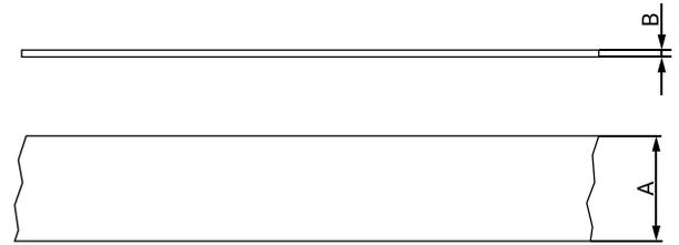
C'est un collier de serrage idéale pour réaliser plusieurs attaches de différents diamètres, offre une fixation sûre et inviolable et résiste aux environnements corrosifs et humides car il est fabriqué en acier inoxydable AISI 304. Il est livré en rouleaux de 50 m, épaisseur 0,4mm et 4 différentes largeurs de bande (9,5 mm à 19 mm). Il est fixé avec des boucles qui s'adaptent aux mesures de la bande et avec une clé spéciale qui serre et coupe.
