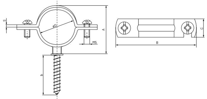
Le vis incorporé peut être dévissé pour faire la fixation au mur et ensuite placer les colliers à travers le filetage.
