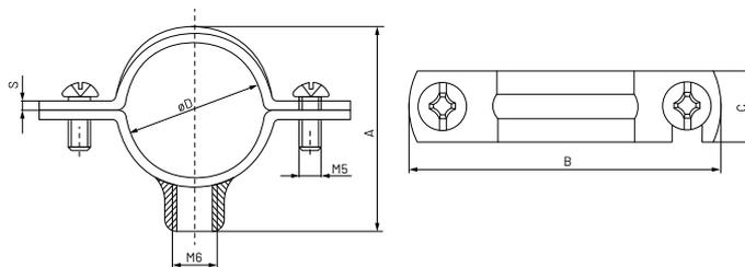
Ce collier de serrage se fixe généralement sur les plafonds et permet de passer un tuyau du diamètre que l'on souhaite. Il est fixé au mur à l'aide d'un vis et d'une cheville, puis le collier est vissé.
