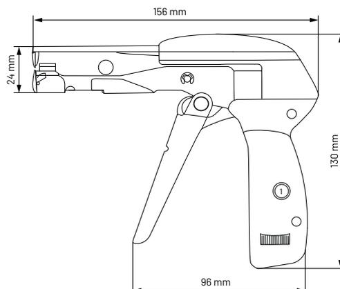
Outil de fixation pour colliers de serrage en nylon de 2,2 mm à 4,8 mm de large et jusqu'à 1,6 mm d'épaisseur. Le collier est coupé automatiquement lorsque l'outil atteint sa tension maximale.
